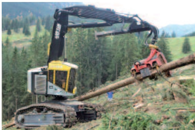
Oben links: Zum Aufarbeitungsplatz am Weg oben ist es noch eine Baumlänge. Der Fahrer läßt den Stamm bergauf durchs Aggregat laufen und entastet ihn dabei. Das kostet Kraft.
