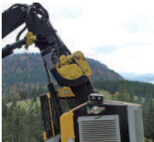
Oben links: Zum Aufarbeitungsplatz am Weg oben ist es noch eine Baumlänge. Der Fahrer läßt den Stamm bergauf durchs Aggregat laufen und entastet ihn dabei. Das kostet Kraft.
