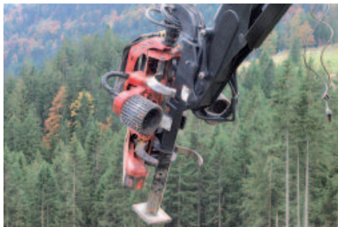
Oben links: Zum Aufarbeitungsplatz am Weg oben ist es noch eine Baumlänge. Der Fahrer läßt den Stamm bergauf durchs Aggregat laufen und entastet ihn dabei. Das kostet Kraft.
