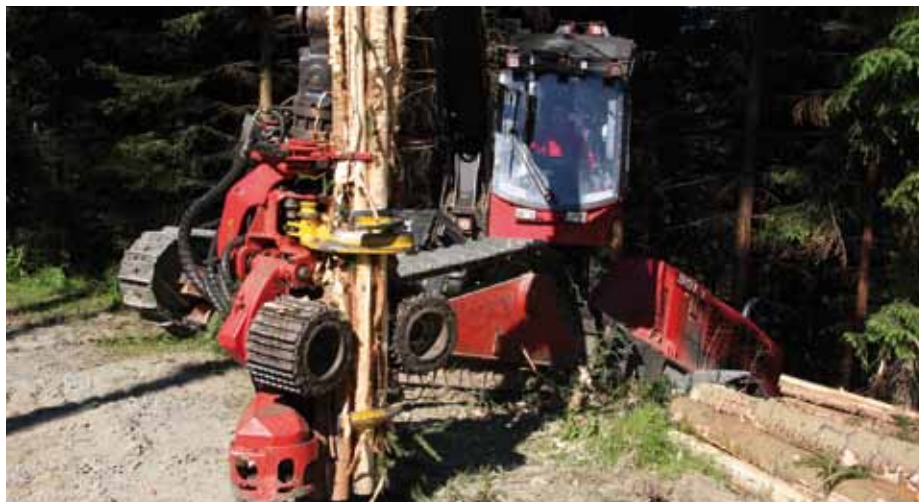
Tauchner wählte bei seinem Aggregat die Zusatzfunktion Mehrfachhandtierung - diese Funktion hilft in Durchforstungsbeständen schnell zu arbeiten.
